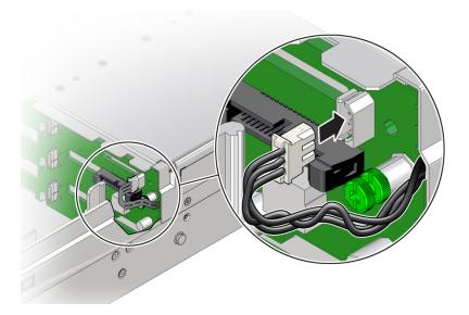
5. Install the fan tray and fan modules.
